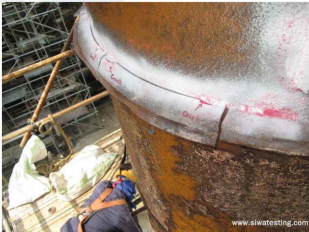
รอยร้าวที่ Insulation Support ทดสอบพบด้วยวิธีการทดสอบด้วยสารแทรกซึม (PT) ถึงแม้ว่าจะไม่เกี่ยวข้องกับ ความมั่นคงแข็งแรงของอุปกรณ์โดยตรง แต่อาจทำให้สิ้นเปลืองพลังงาน
