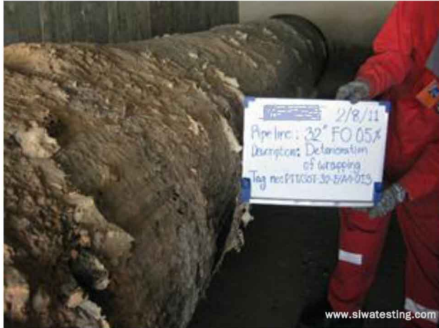
การตรวจสอบ การกัดกร่อนภายใต้ฉนวนของท่อที่ผ่านการใช้งานมานานและมีอุณหภูมิทำงานในช่วงที่เกิดการกัดกร่อนได้ง่าย
