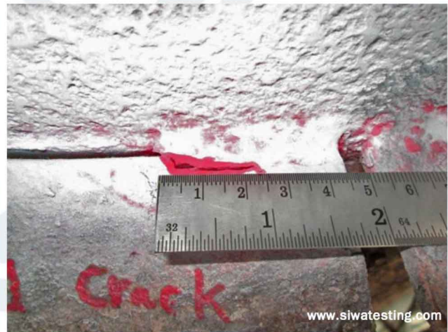
รอยร้าวที่ Insulation Support ทดสอบพบด้วยวิธีการทดสอบด้วยสารแทรกซึม (PT) ถึงแม้ว่าจะไม่เกี่ยวข้องกับ ความมั่นคงแข็งแรงของอุปกรณ์โดยตรง แต่อาจทำให้สิ้นเปลืองพลังงาน
