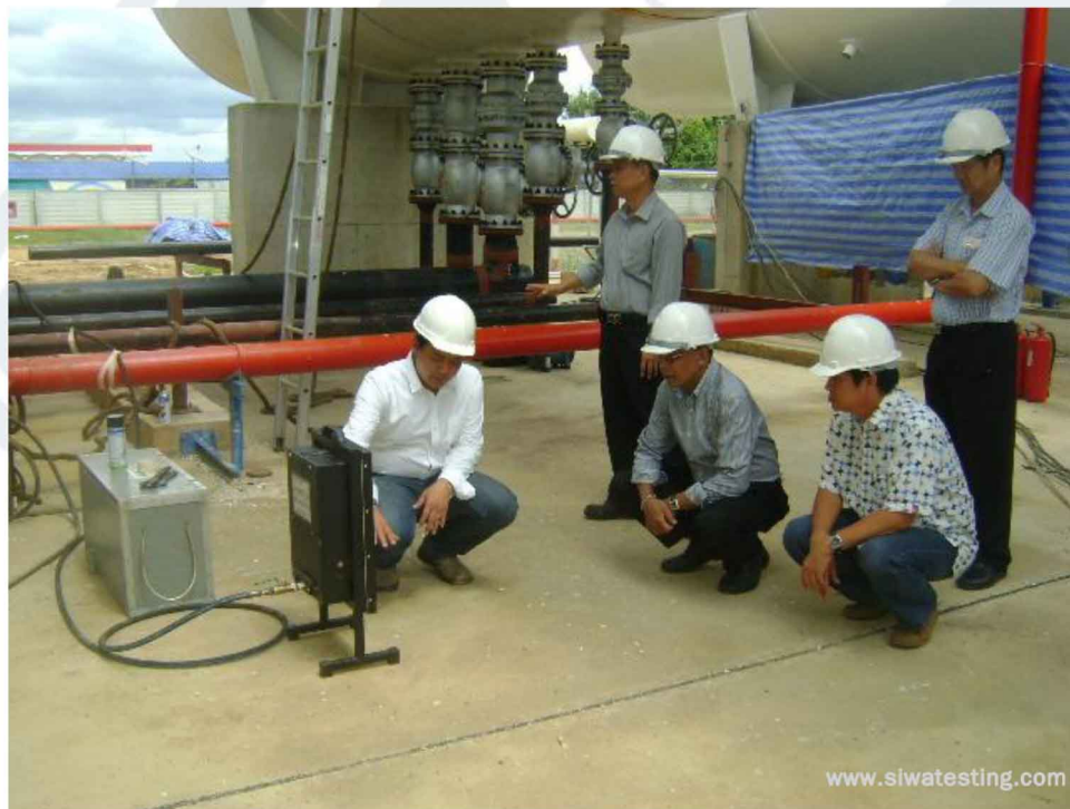
ตรวจสอบ Pressure Chart ในขณะที่เพิ่มความดันและคงความดัน
