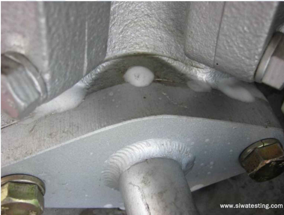
ฟองสนุ่ที่เกิดจากการรั่วซึมของก๊าซ
